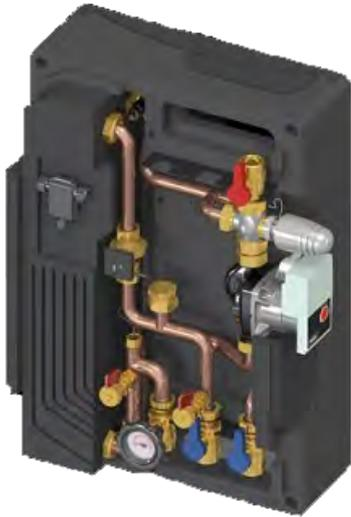
**FERRO FT-FAST i20; 35. Frischwassermodul für 1-6 Wohnungen, bis zu 50l/min.**
