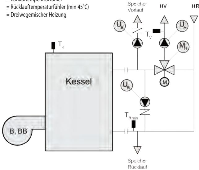
**3.1 Einkesselanlage mit Rücklaufanhebung für Wärmeerzeuger SN; SND, GD**
