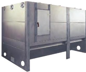
Silobausatz aus verzinktem Stahlblech 2-3mm zur Installation in bestehenden auch schwer zugänglichen Räumen. Die extrem glatte Oberfläche ermöglicht einen Winkel von gerade mal 30°, sorgt für eine optimale Raumausnutzung. Die Konstruktion ist fast vollständig selbsttragend und belastet die Lagerraumwände kaum. Das Silo ist mittig mit einem Auslauftrichter für FERRO Förderschnecken ausgebildet.
