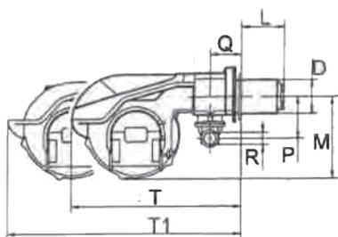
Vollautomatischer Low-NOx Gas-Gebläsebrenner nach EN 676 für Erdgas E und LL bestehend aus: Alu-Druckgußgehäuse, Brennermotor mit direkt gekoppeltem Turbinenrad, schalldämmter Luftsaugschacht mit Regelkappe und Luftabschluß. Schalteinheit, Feuerungsautomat mit Störleuchte, Ionisationsüberwachung, Zündeinrichtung, elektrischer Stellmotor, Motorschutz und Bimmetall, Master- und Wahlschalter, Luftwächter, komplett auf Klemmleiste verdrahtet, elegante Verkleidung des Schalt- und Steuertableaus.
