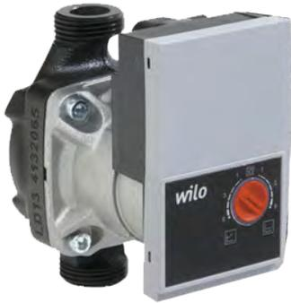
Nassläufer Umwälzpumpe mit Verschraubungsanschluss, EC- Motor und automatischer Leistungsanpassung. Für den Einsatz in Warmwasserheizungen und industriellen Umwälzanlagen mit einem Systemdruck von max. 10 bar. Die stufenlose Leistungsanpassung erfolgt automatisch und ermöglicht eine Stromersparnis von bis zu 80% im Vergleich zu unregelten Umwälzpumpen. Der Lieferumfang umfasst die Wechselstrompumpen mit Dichtungen, Wärmedämmung und Unterlegscheiben für Flanschanschluss (DN32 - DN65).
