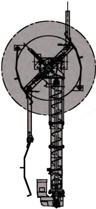
Federstahlarm Belastung: Füllhöhe bis 400cm bei Raumgewicht 250 kg/m³
