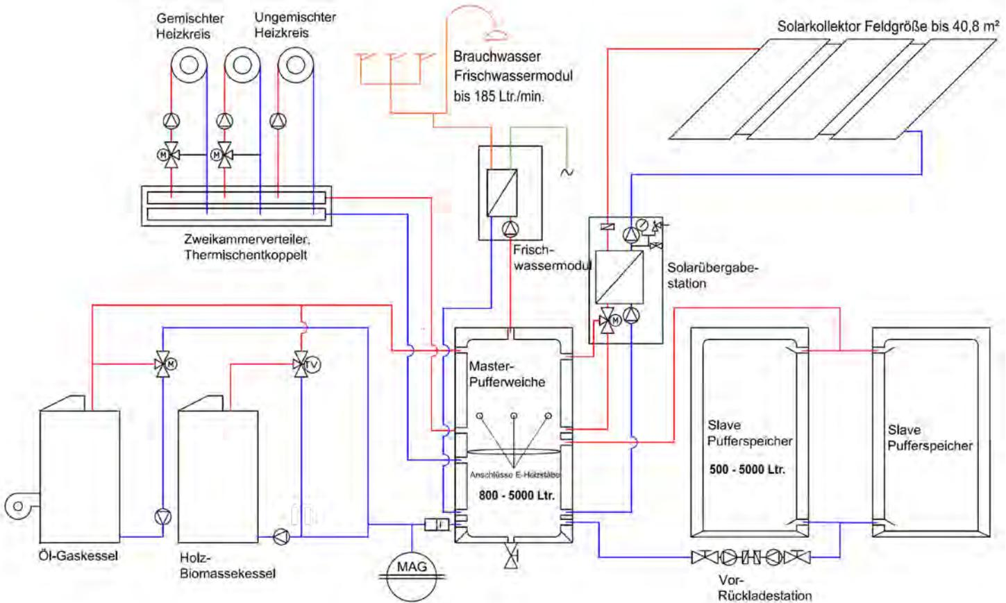
Die zwei- oder Mehrkeselanlage kann auch unterschiedliche Systeme managen, z.B. „Brennwert“, Biomasse, evtl. Kombination Biomasse/Öl.
