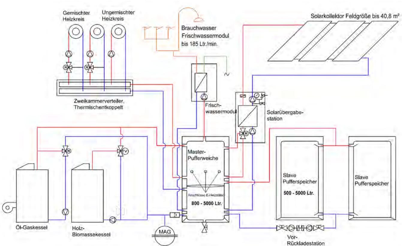
Die zwei- oder Mehrkesselanlage kann auch unterschiedliche Systeme managen, z.B. „Brennwert“, Biomasse, evtl. Kombination Biomasse/Öl.
