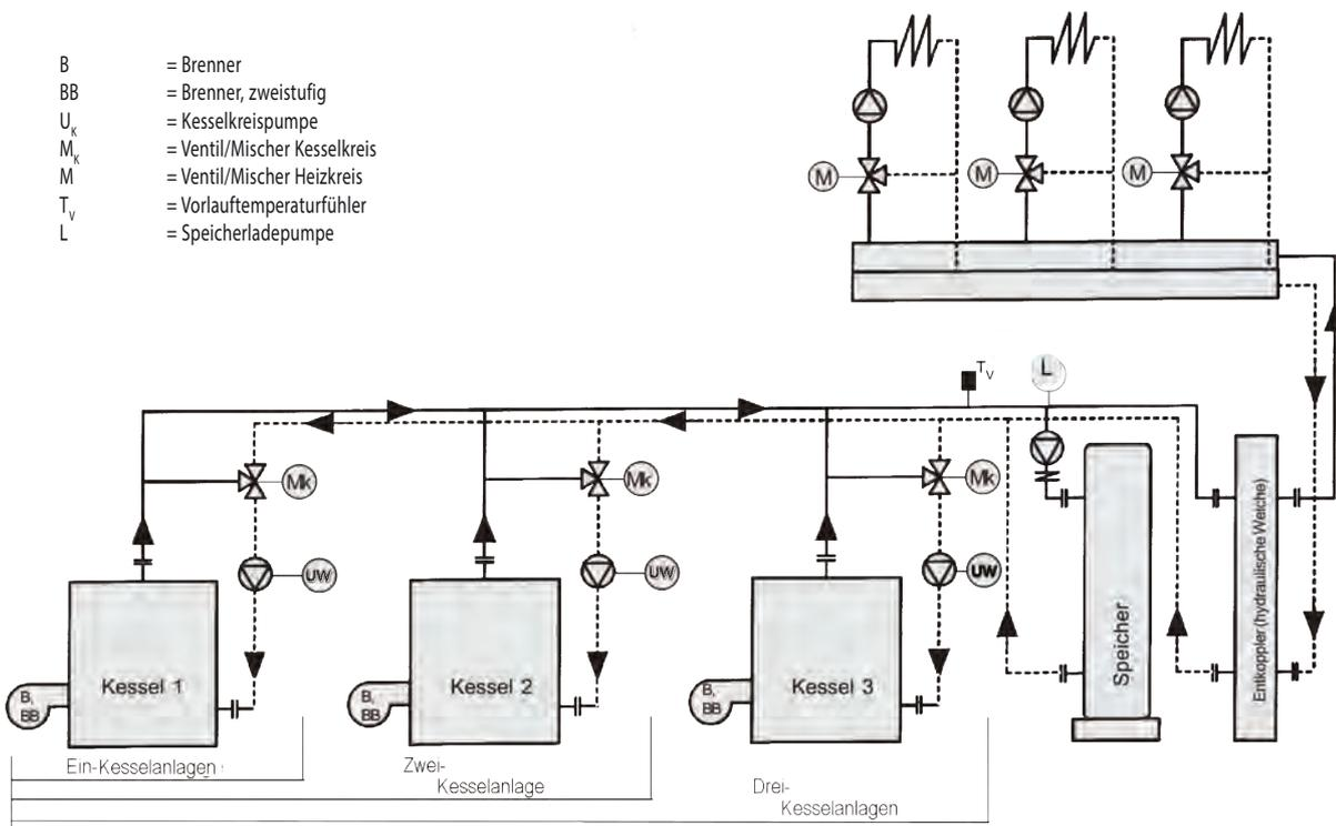
Ein-, Zwei- oder Mehrkesselanlagen werden nach vorstehendem Schema zur Realisierung empfohlen. Die Kesselkreispumpe UW ist auf einen Volumenstrom von ΔT = 15°C auszulegen. Überschlägig gilt: Volumenstrom Kesselkreispumpe= Kesselleistung in kW x 0,057
