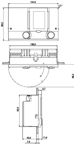
Systemregler in Kompaktbauweise im Normgehäuse (96 x 144mm) mit Stecksockel für Kessel, Wandgehäuse und Schaltschrank - Fronteinbau. Leichte Anwenderbedienung durch Drehknopf- und Fenstertechnik. Anlagenspezifische Daten in codierten Zugangsebenen, passwortgeschützt.
