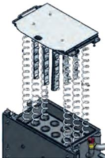
Wirbulatoren (Nr. 10) dienen gleichzeitig zur einfachen Reinigung
