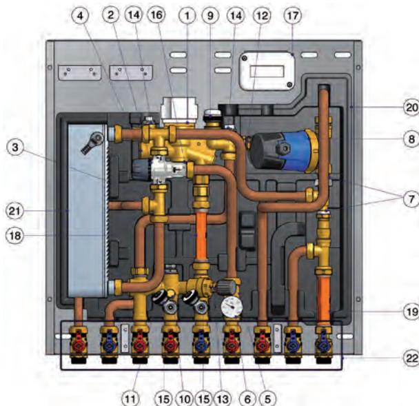
1. Umschaltventil Trinkwasserbereitung
