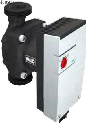
Nassläufer Umwälzpumpe mit Verschraubungsanschluss, EC- Motor und automatischer Leistungsanpassung. Für den Einsatz in Warmwasserheizungen und industriellen Umwälzanlagen mit einem Systemdruck von max. 10 bar. Die stufenlose Leistungsanpassung erfolgt über ein vorgegebenes 0-10V Signal und ermöglicht eine Stromersparnis von bis zu 80% im Vergleich zu unregelten Umwälzpumpen. Der Lieferumfang umfasst die Wechselstrompumpen mit Dichtungen.
