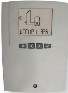
Systemregler im Gehäuse für Wandaufbau. Leichte Anwenderbedienung durch Funktionstasten und Display. Wahlweise als Solarregler, Vor-Rückladeregler für mehrere Pufferspeicher, Rücklaufregler. Drehzahlgeregelte Pumpenlogik, Solarertragsoptimierung mit Lademanagement, 3 wechselseitig einsetzbare Fühlereingänge, 2 Schaltausgänge 230V.
