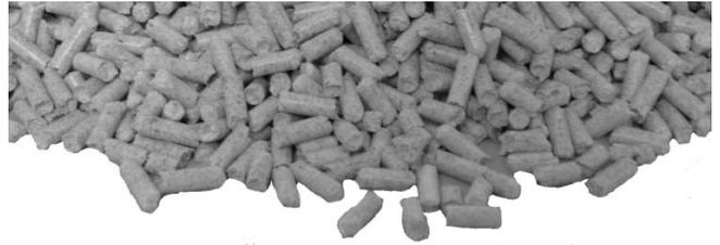
Pellets setzen sich aus verschiedenen gepressten Holzsorten zusammen und werden in einem mechanischen Verfahren unter Einhaltung der Umweltbestimmungen hergestellt.
