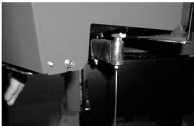
3.6.9 Brenner in den Kessel einschwenken und mit den Halteklammern befestigen. Es ist auf dichten Sitz zu achten. Gegebenfalls Haltebügel nachjustieren
