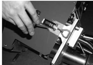
3.6.4 Montieren Sie den Haltebolzen für den Gelenkarm am Pelletbrenner
