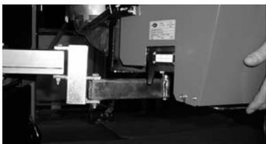
3.6.8 Mittels eines Inbus kann die Höhe des Brenners angepasst werden sollte sich der Brenner nicht in den Kessel schwenken lassen.
