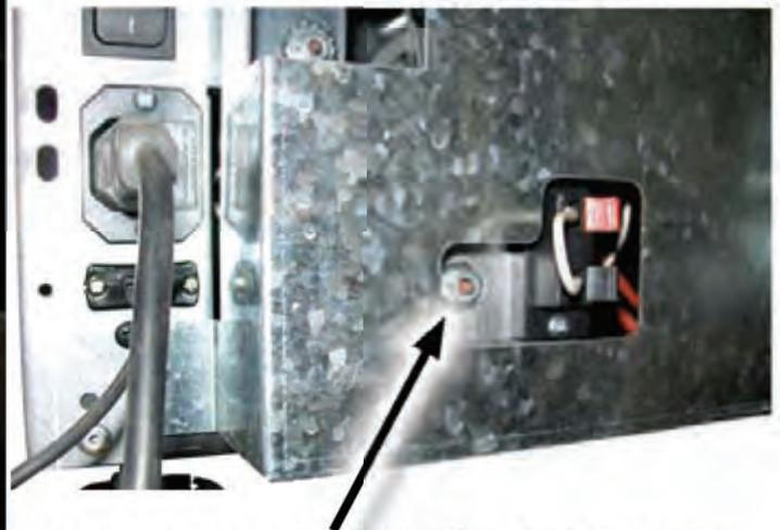
Rückstellen des 100 °C-Kapillarrohrthermostats
