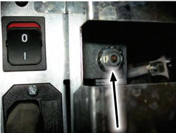
Rückstellen des 85 °C-Kapillarrohrthermostats
