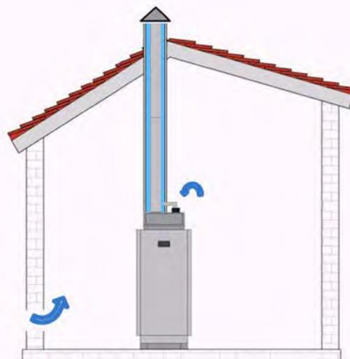
Raumluftunabhängiger Betrieb , koaxial
