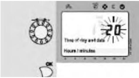
Jetzt blinken die Minuten auf dem Display. Stellen Sie die Minuten mit dem Drehknopf ein. Zum Bestätigen OK drücken.
