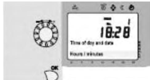
Im unteren Teil des Display erscheint dann die erste Zeile der Betriebsseite "Zeit". Drehen Sie den Einstellungsknopf bis zur Zeile "Stunden/Minuten". Zum Bestätigen OK drücken.
