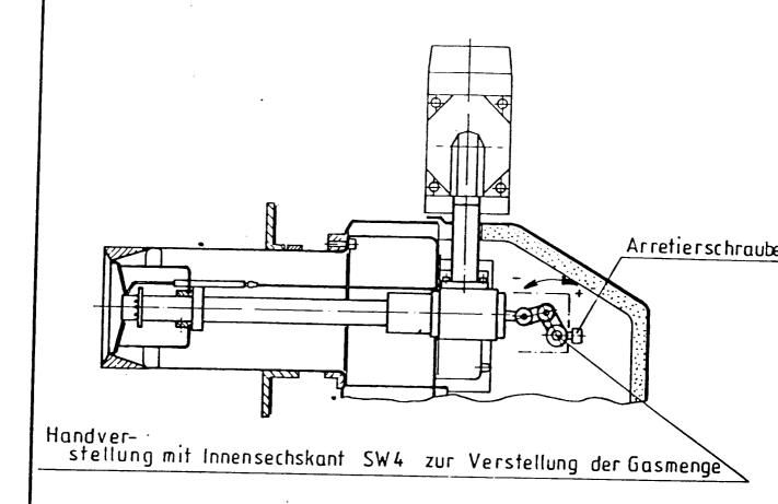
Die Einstellung der gewühschten Gasmenge wird mittels 4 mm Innensechskantschlüssel an der Handverstellung vorgenommen links drehen = weniger Gas rechts drehen = mehr Gas
