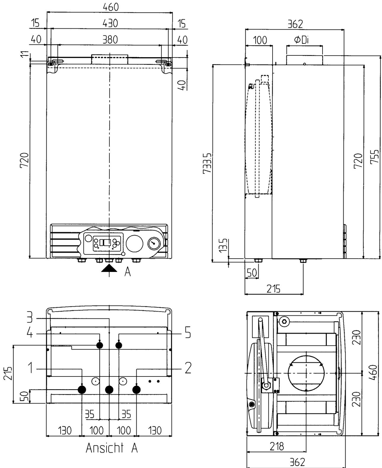
Abb. 2.2 Geräteabmessungen UW 18/24 M
