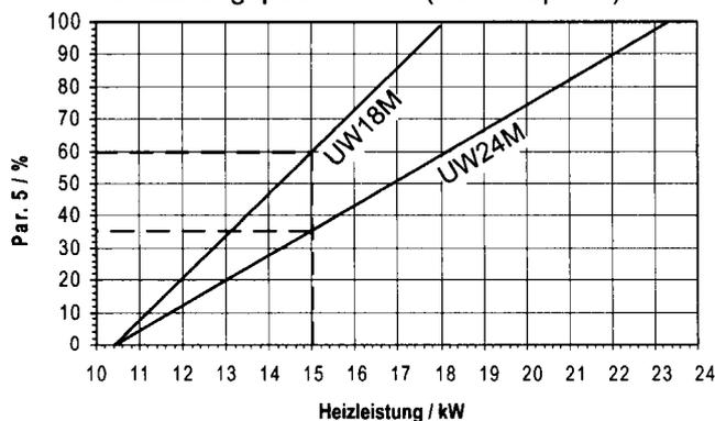
**Beispiel:** Bei einer Heizleistung von 15 kW muß der Parameter 5 auf den Wert 36 (UW 24 M), bzw. 60 (UW 18 M) gestellt werden.
