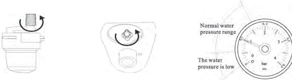
4. Wenn der Gasschalter nicht eingeschaltet ist, lassen Sie die Gasheizung und den Warmwasser~Kombi~Kessel laufen, und wenn der Systemwasserdruck unter 1 Bar fällt, öffnen Sie das Zusatzwasserventil, um weiterhin Wasser in das System zu ergänzen, bis der Wasserdruck innerhalb von 1Bar~1.5Bar liegt.
