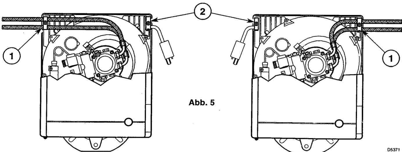
Die Ölschläuche werden mit den Winkelanschlüssen an der Ölpumpe montiert, wobei die Ölschläuche nach links oder nach rechts aus dem Brenner herausgeführt werden können.
