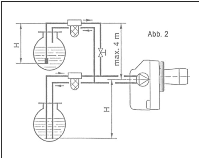
In der Brennstoff-Ansaugleitung muss ein Filter eingebaut werden.
