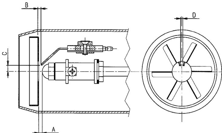
Nach Montage der Düsen die korrekte Position der Elektroden und der Stauscheibe nach den unten angegebenen Werten überprüfen. Eine Überprüfung der Werte ist nach jedem Eingriff auf dem Brennerkopf zu empfehlen.
