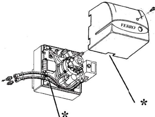
\* Beide Schläuche müssen wie in der gegenüberliegenden Zeichnung positioniert werden, um die Brennerhaube richtig zu montieren. Sie können im unteren oder im linken Teil des Brenners herausgeführt werden.
