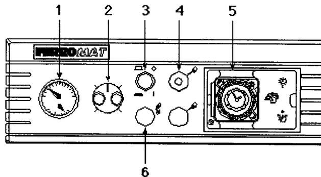
**Schaltfeld:** 1 = Thermo / Manometer; 0 bis 120°C / 0 bis 6 bar
