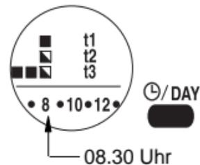
Es besteht der Wunsch, die Temperatur ab 08.30 Uhr statt ab 09.00 Uhr zu ändern. Die Taste **☹/Day** drücken, um zur Programmierung des vorangehenden Uhrzeitpunktes zurückzukehren. Nun besteht die Möglichkeit, die zweite halbe Stunde (30 ÷ 59) zu ändern. Die erste halbe Stunde (00 ÷ 30) ist bereits festgelegt, was durch den festen (nicht blinkenden) Punkt angezeigt ist. Die zweite halbe Stunde kann durch Anwahl eines der verbleibenden, blinkenden Temperaturpunkte programmiert werden.
