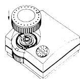
• Einstellknopf auf die Achse aufstecken. Vor dem Aufstecken den Einstellbereich (falls erwünscht) verkleinern. Dazu müssen die roten Reiter angehoben und in die gewünschte Position verschoben werden. (Werkseitige Einstellung: 15-25 °C).
