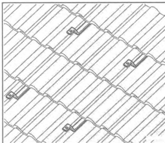
Pro Kollektorfeld benötigen Sie vier Dachhaken, diese müssen horizontal und vertikal fluchtend sein.
